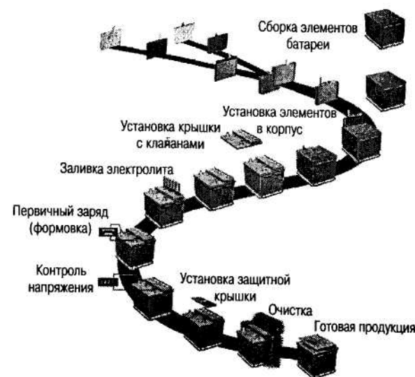
Рис. 3.4. Цикл производства автомобильных свинцово-кислотных батарей (пример)
