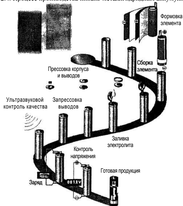
Рис. 2.4. Процесс производства никель-металлгидридных аккумуляторов
