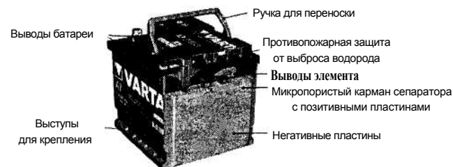
Рис. 3.3. Устройство автомобильной батареи Varta
