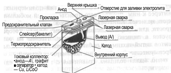
Рис. 4.3. Конструкция литий-ионного аккумулятора в призматическом корпусе
