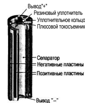
Рис. 2.3. Устройство никель-металлгидридного аккумулятора
