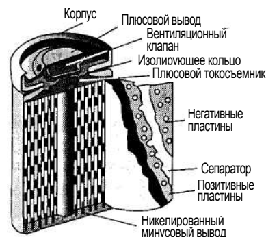
Рис. 2.2. Устройство никель-кадмиевого аккумулятора
