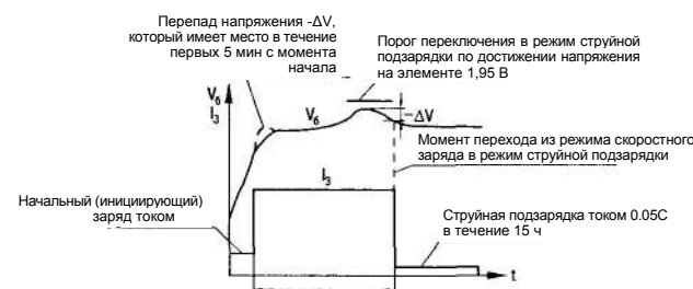
Рис. 2.19. Реальная характеристика работы скоростного \Delta V -зарядного устройства
