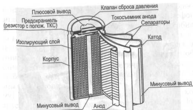
Рис. 4.1. Устройство литий-ионного аккумулятора
